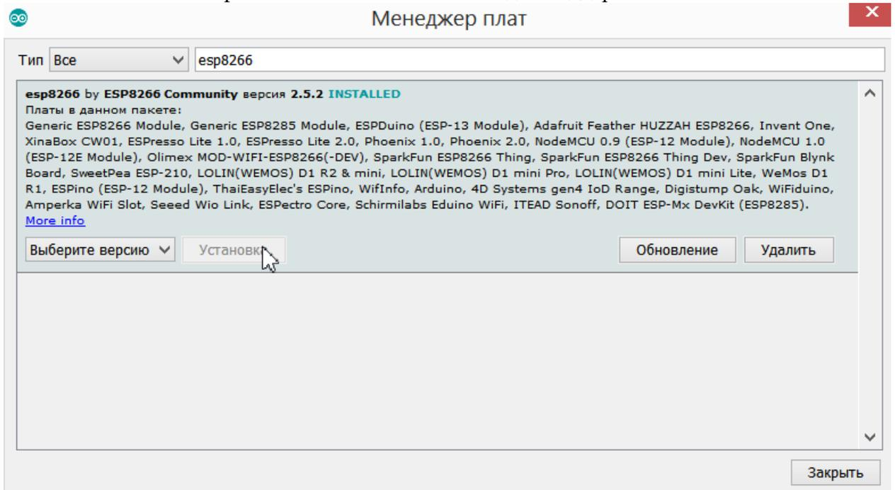
6. Выбираем нужную плату для прошивки. В нашем случае NodeMCU 1.0 (ESP-12E Module).
