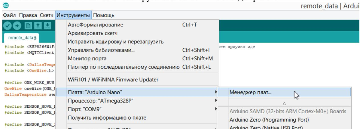
5. В поиске вбиваем esp8266. Устанавливаем пакет для поддержки плат.
