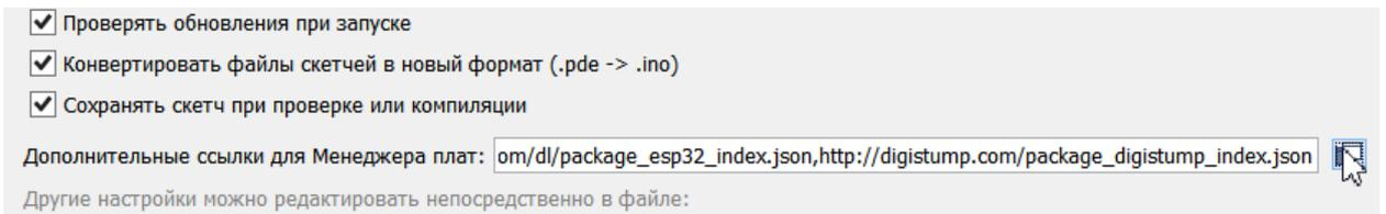
3. Добавляем строку: `http://arduino.esp8266.com/stable/package_esp8266com_index.json`
