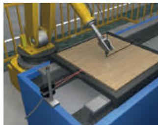
Обнаружение тары при конвейерной транспортировке сельхозпродукции
