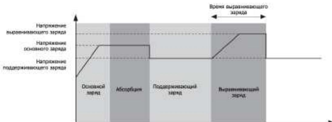
Тем не менее, если на этапе выравнивания напряжение на батарее не успело достигнуть напряжения выравнивающего заряда за установленное время, выравнивающий заряд будет продлен, но не далее
