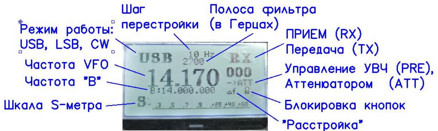
В левом верхнем углу экрана отображается текущий режим работы: верхняя боковая полоса (USB), Нижняя боковая частота (LSB) или телеграфный режим (CW).
