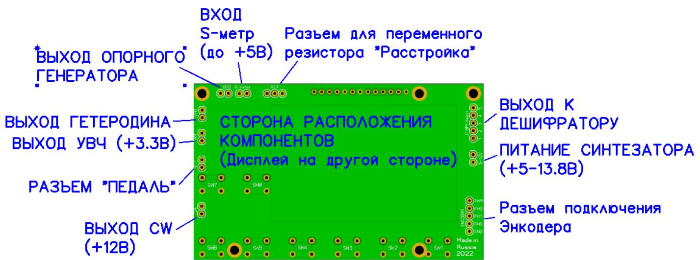
**Выход к дешифратору (отмечен на плате как “J7 BPF Select”)** – предназначен для передачи 4-х битного сигнала +3.3В на плату дешифратора. Дешифратор в свою очередь переводит и усиливает этот сигнал до 12В (или выше при необходимости) для последующего управления реле переключения диапазонами на фильтрах ДПФ и ФНЧ.
