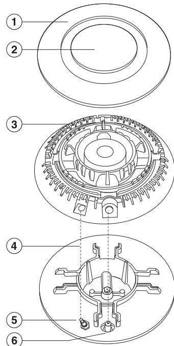
■ Поставьте головку горелки ③ на её основание ④ таким образом, чтобы термоэлемент ⑤, электроподжиг ⑥ и стопорные болты ⑦ вошли в отверстия головки горелки.
