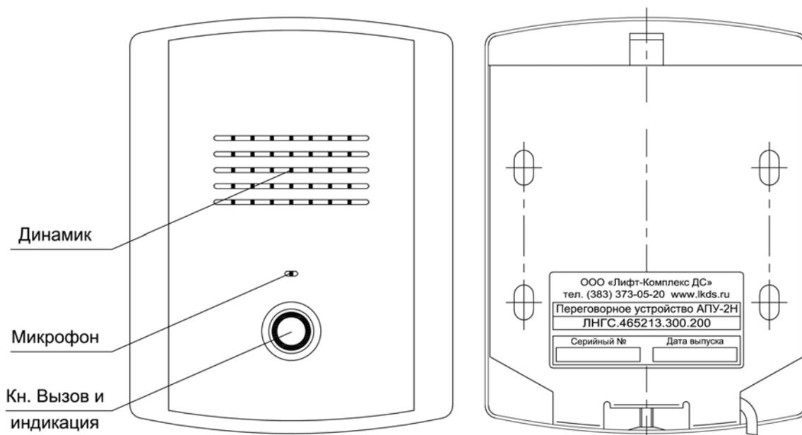
**Рис.1 Внешний вид этажного Переговорного устройства АПУ-2Н**
