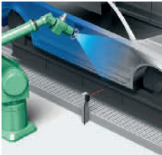
Рабочая поверхность датчика загрязняется краской
