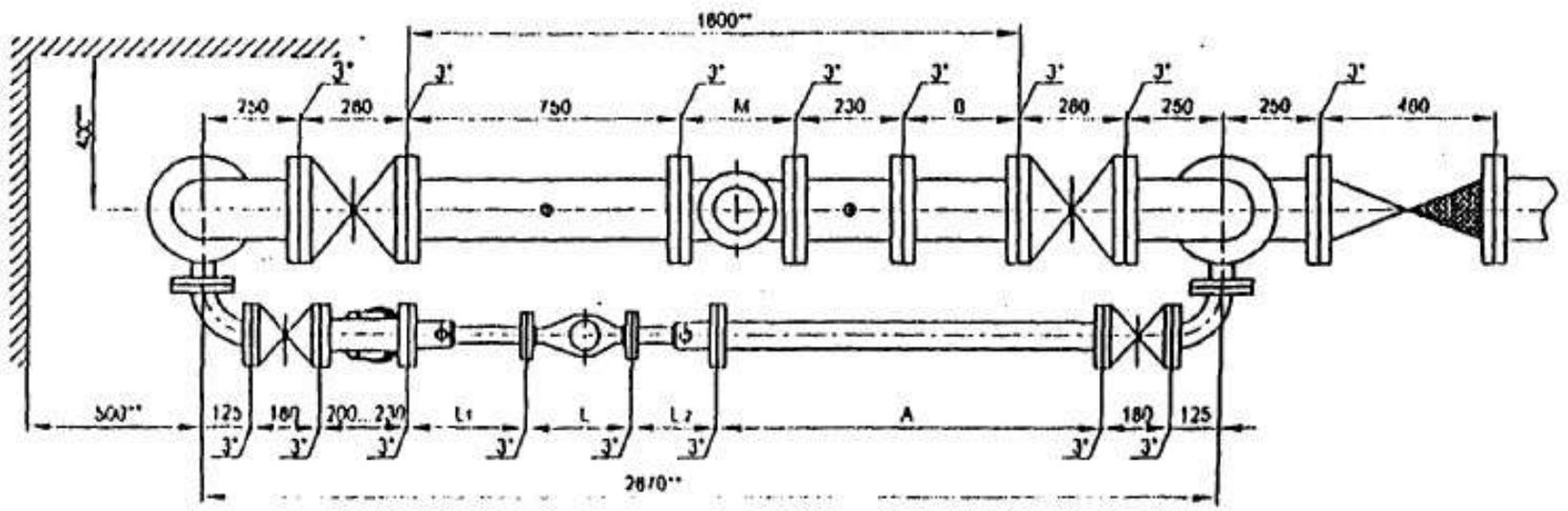
Установка счетчиков  $d_u=20...50$  мм на хозяйственно-питьевой линии и счетчика  $d_u=150$  мм на пожарно-разрывной линии и водомерном узле на вводе диаметром 150 мм.
