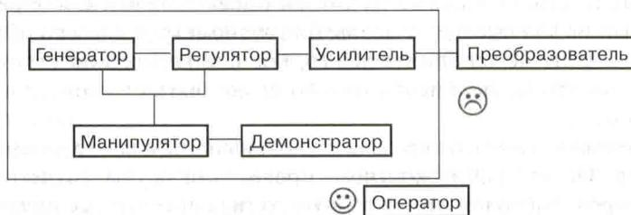
Рис. 8.1. Упрощенная блоковая схема аудиометра
