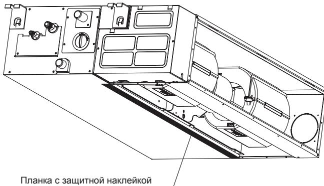
Установите воздушный фильтр. При установке фильтра прислоните его сначала со стороны выходного отверстия для воздуха, задвиньте внутрь и вверх.
