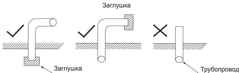
При подаче трубы через отверстие в стене обязательно одевайте заглушку на конец трубы.
