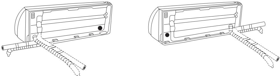
Будьте крайне осторожны, чтобы не погнуть (запомять) трубопровод при изгибе его от блока. Любые повреждения трубопровода влияют на рабочие характеристики установки.
