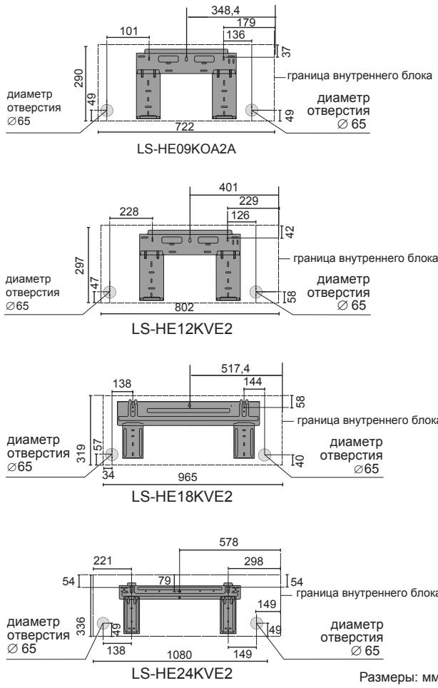
Если соединительная труба со стороны газа имеет Ø 16 мм или более, отверстие в стене должно быть Ø 90 мм.
