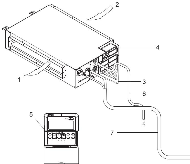
1 — выход обработанного воздуха; 2 — вход воздуха; 3 — фильтр; 4 — плата управления (под защитной крышкой); 5 — пульт управления; 6 — трубопровод конденсата; 7 — трубопроводы хладагента
