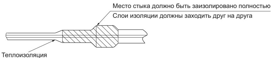
Теплоизоляцию закрепите монтажным скотчем.
