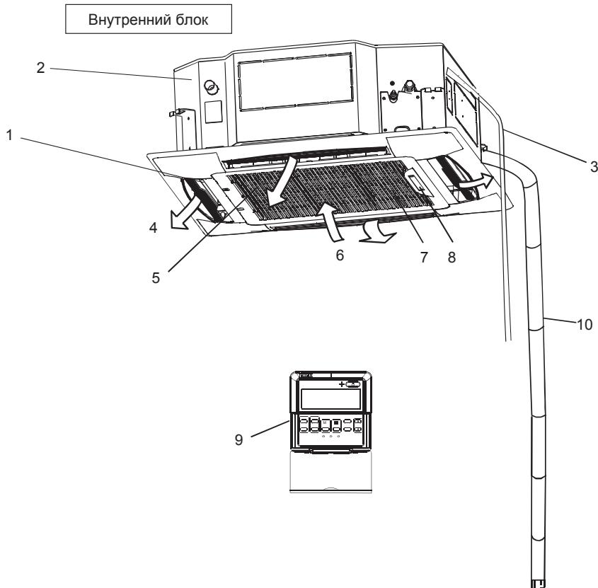
1 — выход воздуха через жалюзи; 2 — помпа для слива конденсата; 3 — трубопровод конденсата;
