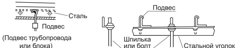
Подвесьте внутренний блок за кронштейны на подвесные болты (шпильки).
