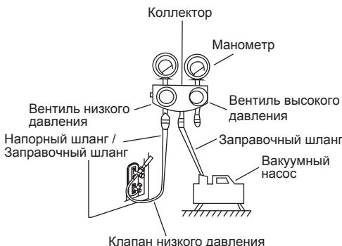
Убедитесь, что все трубопроводы (жидкостные и газовые) подключены верно. Снимите колпачки с вентилями, и обратите внимание, что вентили на газовых и жидкостных магистралях остаются закрытыми во время процесса вакуумирования.
