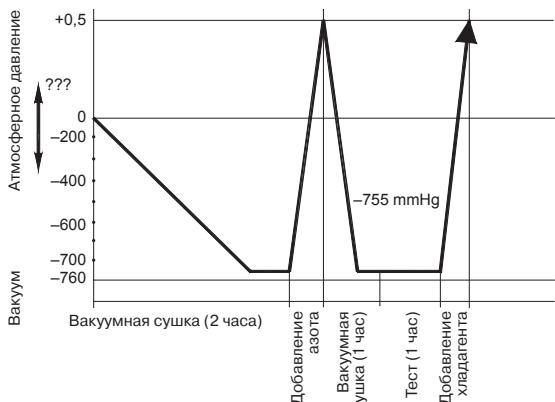
После первого вакуумирования добавьте в контур осущененный азот при давлении до 25 кг/см<sup>2</sup> на 30 минут. Удалите азот и снова отвакуумируйте систему.
