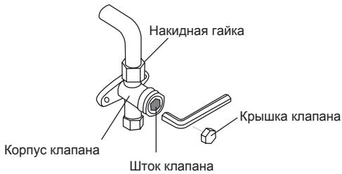
Используя шестигранный ключ, полностью откройте клапаны высокого и низкого давления. Затяните крышки клапанов на трех портах (сервисныйпорт, высокое давление, низкое давление) вручную. При необходимости вы можете затянуть его еще сильнее с помощью динамометрического ключа.
