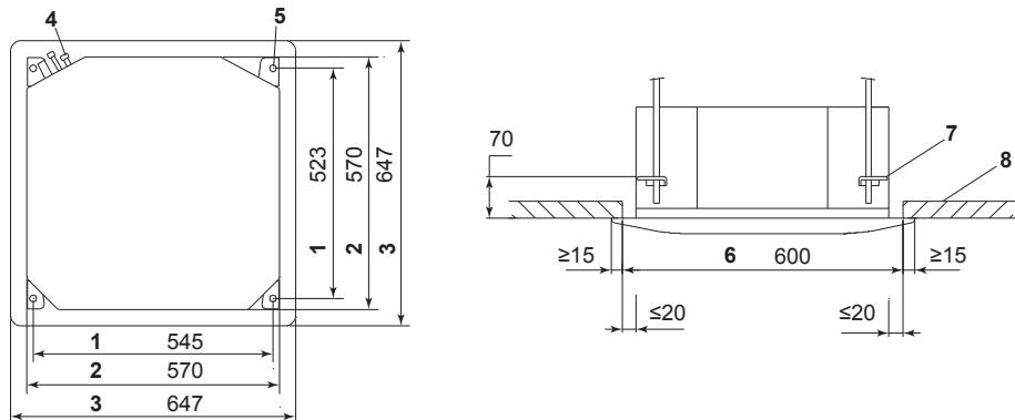
1 — петли крепления внутреннего блока; 2 — размеры внутреннего блока; 3 — размеры панели внутреннего блока; 4 — трубопроводы; 5 — петли крепления (×4); 6 — отверстие в потолке; 7 — шпильки в ушах крепления внутреннего блока; 8 — фальш-потолок
