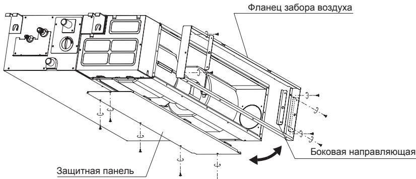
Установите планку с защитным покрытием, закрепите направляющие и фланец, закрепите защитную крышку.
