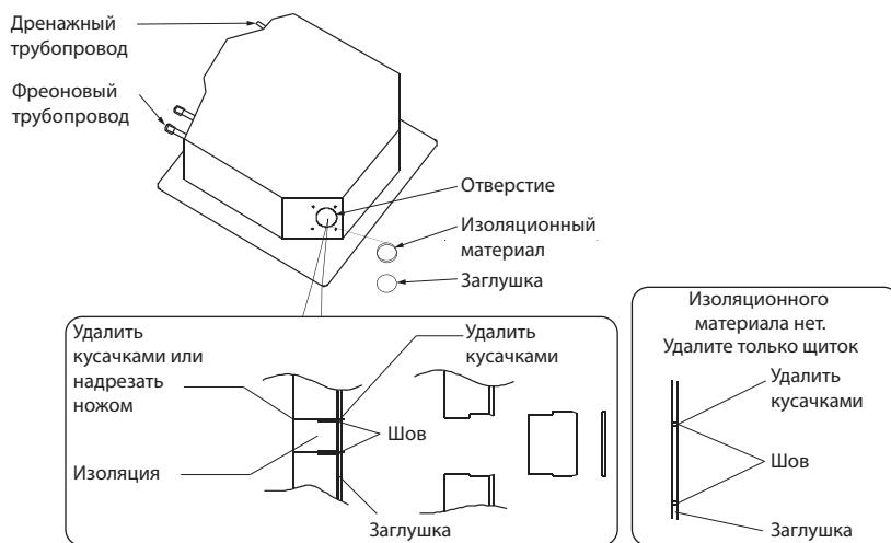
2. Установите на корпус (приклейте) изоляционный материал.
