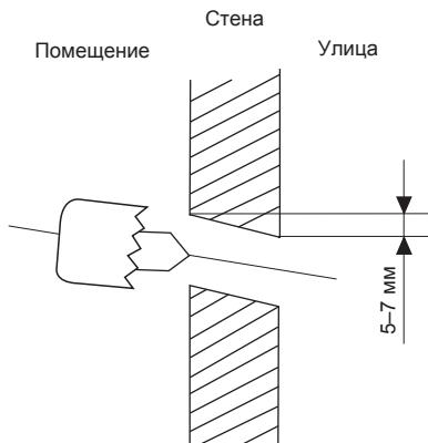
Всегда используйте пластиковую монтажную гильзу или кабель-канал для защиты трубопроводов в стене.
