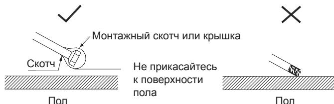
3. Отрезайте трубу и удаляйте заусеницы, направив обрабатываемый конец вниз.
