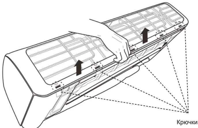
6. Вымойте переднюю панель в воде с нейтральными моющими средствами. Перед мойкой снимите дисплей с передней панели.
