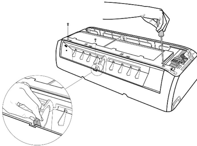
4. Потяните переднюю панель в направлении, указанном на иллюстрации ниже, чтобы снять ее.
