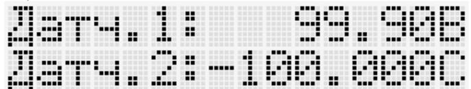
Та же информация в режиме реальных данных, когда к первому каналу был подключен аналоговый датчик, выдающий показания от 0 до 100 бар при давлении в 100 бар, а ко второму датчик аналоговый термодатчик измеряющий температуру от -100 до +100 градусов Цельсия, при температуре -100 градусов.
