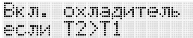
В зависимости от того на охлаждение или на нагрев была запрограммирована программа на предыдущих шагах. Тут можно изменять второй датчик, на рисунке - "T1", где "1" логический номер датчика. Изменения производятся кнопками «влево»/«вправо». В данном случае гистерезис сравнения установлен жёстко и равен +0.5 градусов Цельсия. К следующему меню – ENTER.
