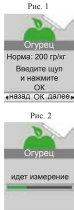
На экране отобразится норма для выбранного продукта (рис.1) в мг/кг. Далее введите шуп прибора в измеряемый продукт и нажмите «ОК» или стрелку «Вправо» (далее). В процессе измерения (рис.2) на экране отобразится шкала загрузки.
