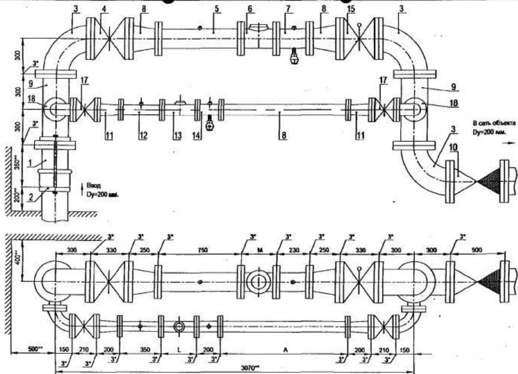
Установка счетчика  $d_y=65$  мм на хозяйствственно-питьевой линии и счетчика  $d_y=150$  мм на пожарно-резервной линии в водомерном узле на воде диаметром 200 мм.
