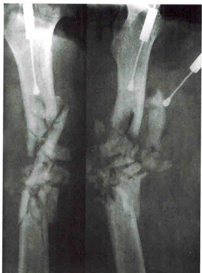
Рис. 2.5. Рентгенограмма бедра биоманекена с нанесенным огнестрельным переломом бедренной кости и датчиками давления, расположенными в мозговой полости и в мышцах
