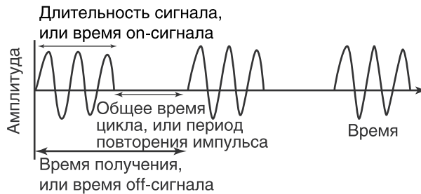
Рис. 2.5. Режим импульсного ультразвука зависит от излучаемого импульса из 2–4 циклов волн с последующим периодом «покоя», поскольку датчик ожидает возвращения излученных импульсов
