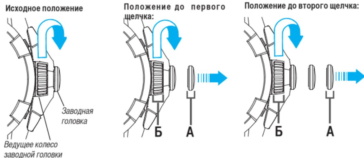
Чтобы вытянуть головку, тяните **часть А** (заводная головка).
