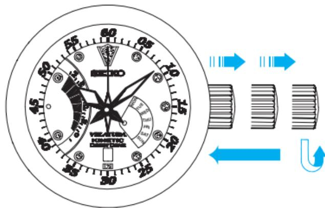
1. Вытяните заводную головку до второго щелчка, когда секундная стрелка находится в положении 12 часов.
