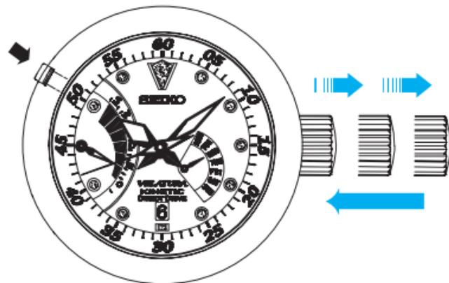
1. Вытяните заводную головку в положение до второго щелчка.
