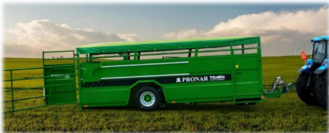
Одноосный прицеп PRONAR T046H – это новейшее решение Pronar, предназначенное для перевозки животных. Тщательно продуманная и изысканная конструкция позволяет безопасно и комфортно перевозить до 8 штук крупного (до 700 кг) скота или 10 штук более легкого (до 550 кг).
