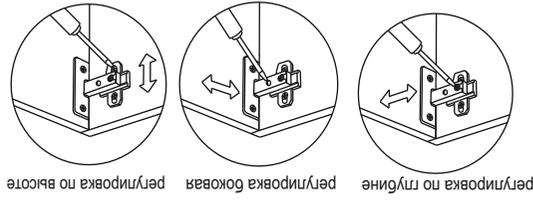
регулировка по глубине
