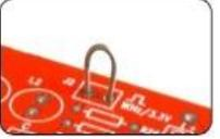
Сделайте небольшую петлю из обрезка ножки резистора. Впаяйте петлю в два отверстия J2 как на фото
