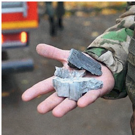
Рис. 1.1. Осколки естественно-дробимого корпуса разорвавшегося традиционного снаряда
