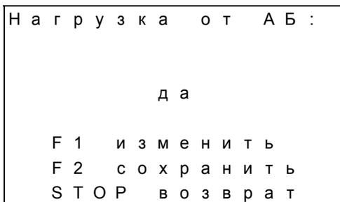
**Рис.34. Запрет/разрешения питания нагрузки от АБ**
