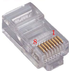
Рис.51. Контакты разъема RS-485 на стороне ИБП
