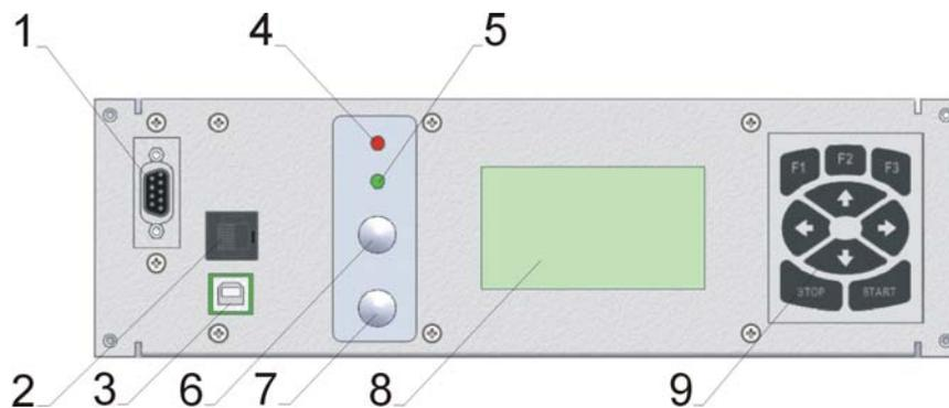
**Рис. 3 Передняя панель модуля индикации**
