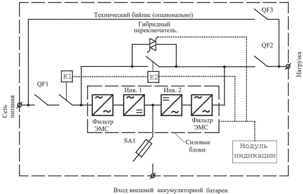
**Рис. 4 Структурная схема ИБП**
