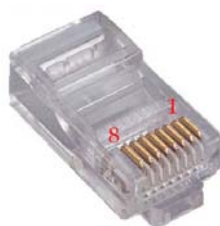
Рис.55. Контакты разъема RS-485 на стороне ИБП
