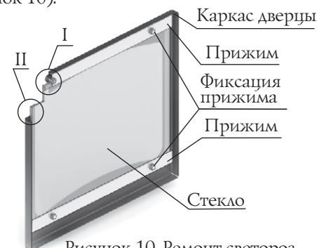
Рисунок 10. Ремонт светопрозрачного экрана дверцы.
