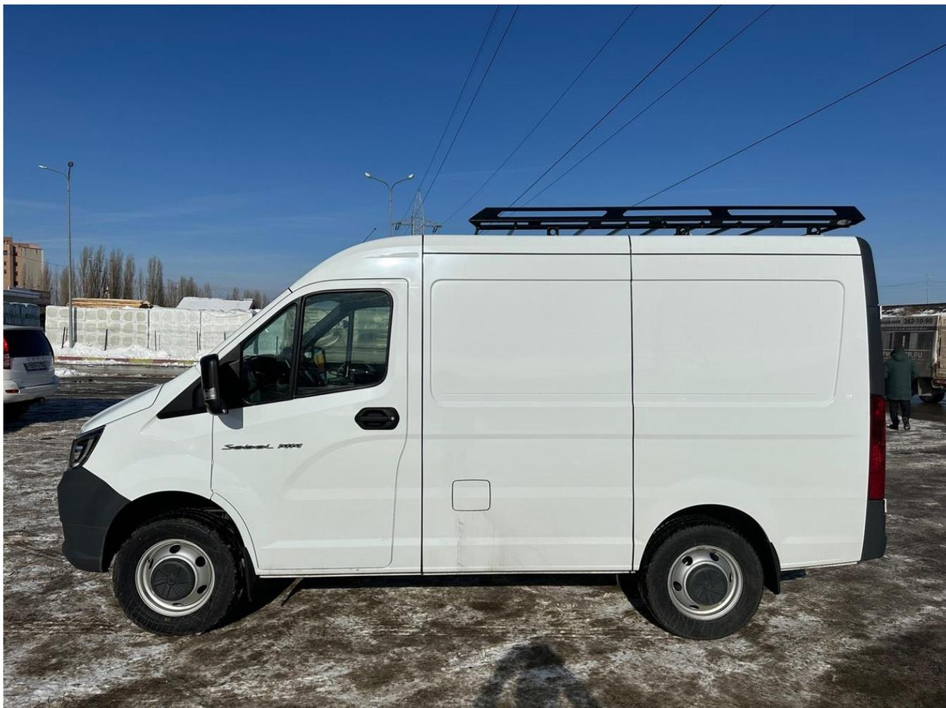
Рисунок 2 - Установленный багажник на автомобиле
