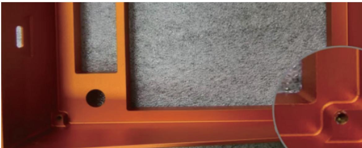
3. После сборки кита могут остаться небольшие зазоры в силу практических навыков человека. Стандарт контроля качества для зазоров - до 0,2 мм. Если после сборки зазоры между деталями превышают 0,2 мм, пожалуйста, выкрутите винты и скорректируйте их положение. Если после регулировки зазоры по-прежнему
