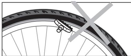
2/ Проверьте расстояние от тормозных колодок до обода (от 1 до 3 мм таким образом, чтобы достичь эффективного торможения).
