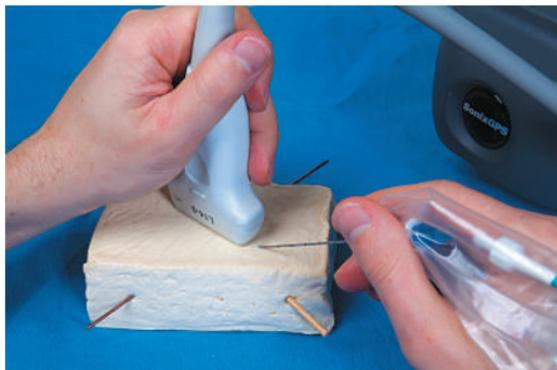
**Рис. 4.7.** Фотография сложной модели на сыре тофу с тонкой целью и иглой для проводниковой блокады
