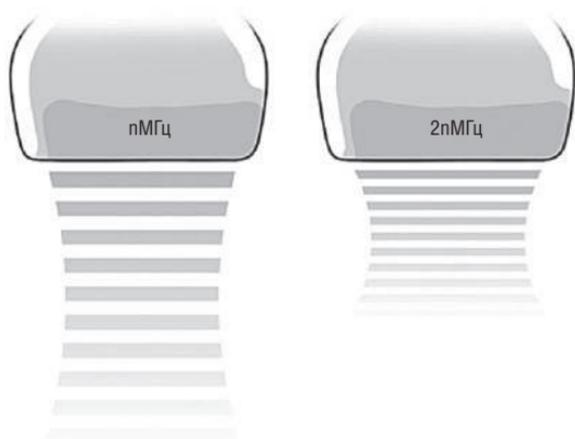
**Рис. 1.4.** Схематичное изображение датчиков с разной частотой излучения
