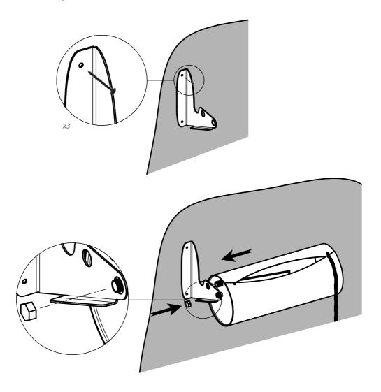
3) Вставьте ось на противоположной стороне корпуса  $\bf A$  в отверстие на втором кронштейне  $\bf F$ . Накрутите гайку-фиксатор  $\bf B$  на ось устройства. Закрепите кронштейн  $\bf F$  на стене.
