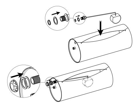
2) Установите цепь с ручкой **D** и закрепите ее с помощью гайки-барашка **E**.
