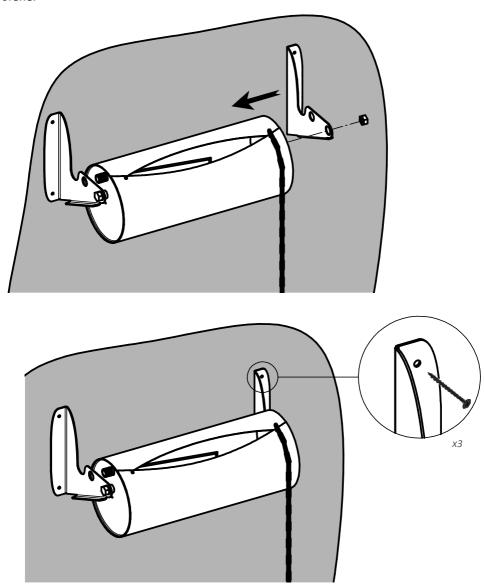
Примечание: выше описан порядок сборки и установки обливного устройства на стену. Процесс установки на потолок аналогичен, за исключением того, что ось корпуса **A** устанавливается в отверстия у основания кронштейнов **F**.
