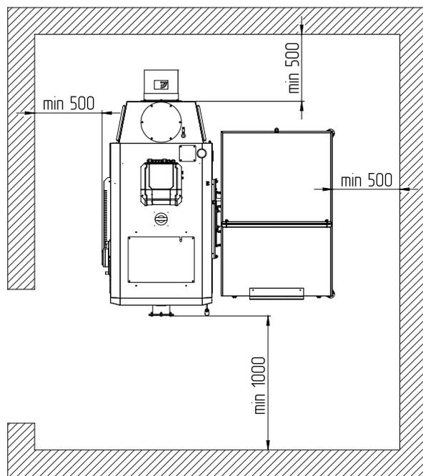
**Рис.7** Расположение котла в помещении котельной
