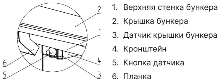
**Рис.16 Установка датчика крышки бункера.**
