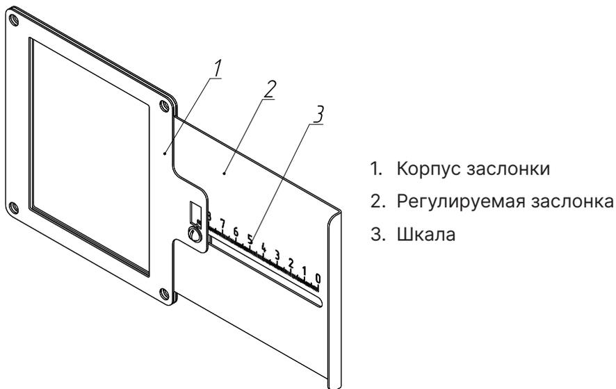
**Рис.18 Заслонка вентилятора**
