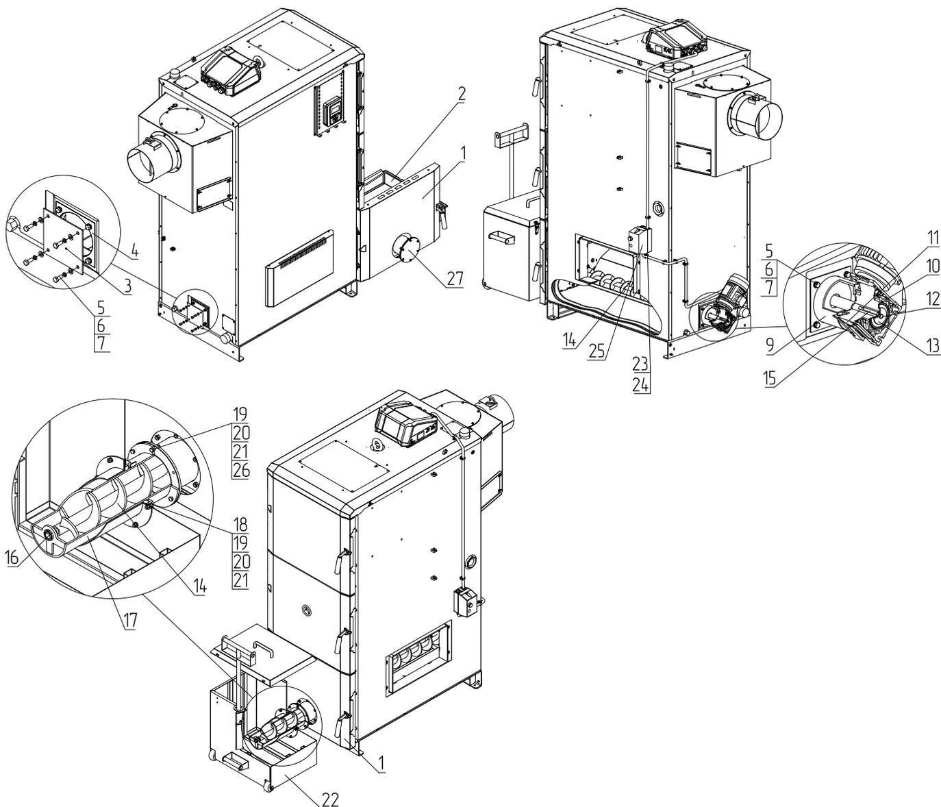
**Рис.15 Монтаж золоудаления котла ZOTA Staharov 85-135 кВт**
