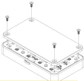
Установите акриловую крышку с помощью 4-х винтов
