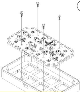
Установите плату в корпус с помощью 4-х винтов
