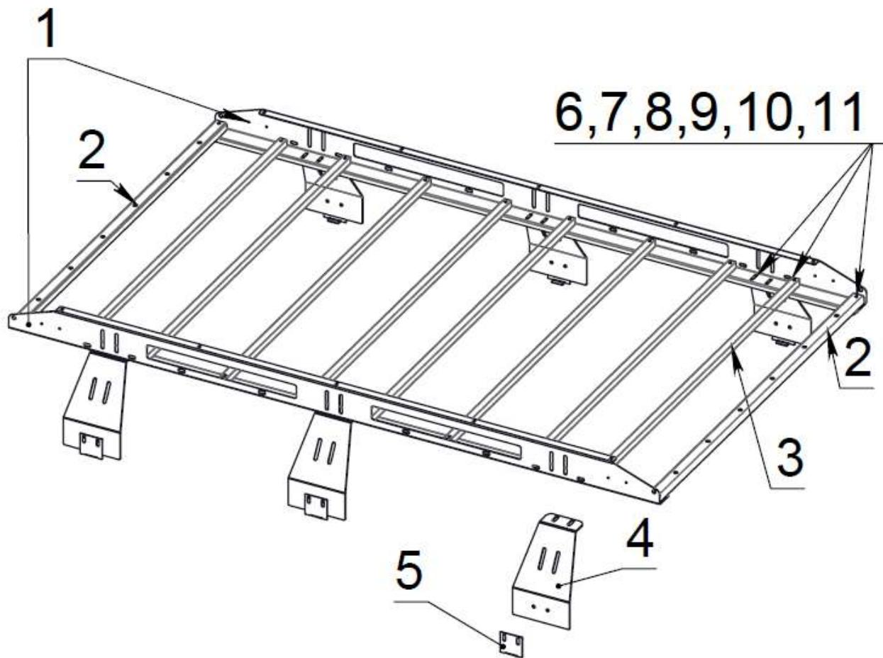
Рис. 2. Детали багажника.
