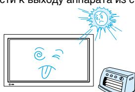
Для обеспечения необходимой вентиляции установите аппарат на расстоянии не менее 10 см от стены.
