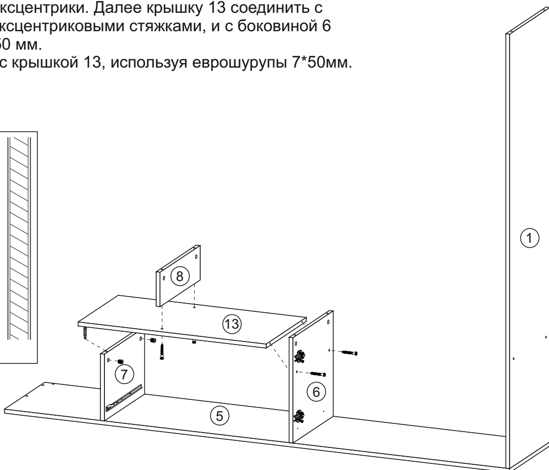
Монтаж эксцентриковой стяжки
