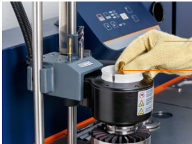
Abb. 10: Beim Schrumpfprozess Werkzeug mit Handschuh halten.
