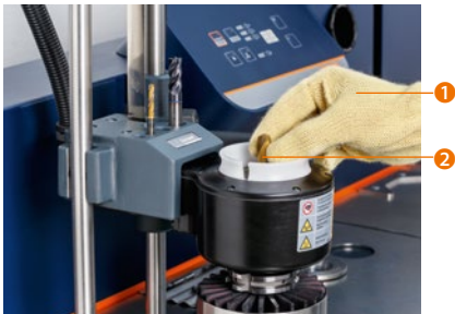
Fig. 10: Utilizar un guante para sujetar la herramienta durante el proceso de contracción.
