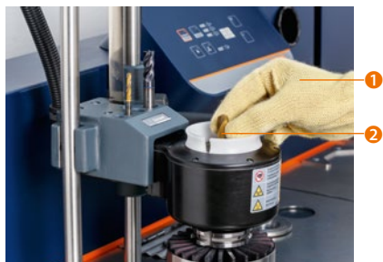
Obr. 10: Při smršťování držte nástroj v rukavicích.
