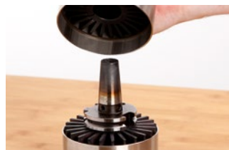
Fig. 11: Mise en place de l'adaptateur de refroidissement
