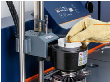
Рис. 10: В процессе термического зажима и разжима держать инструмент рукой в перчатке.
