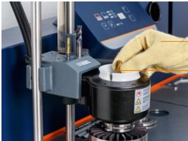
Fig. 10: Tenere l'utensile con il guanto durante il calettamento.
