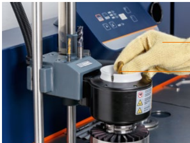
Fig. 10: Lors du frettage, portez des gants pour tenir l'outil.
