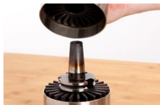
Fig. 11: Colocación del adaptador de refrigeración
