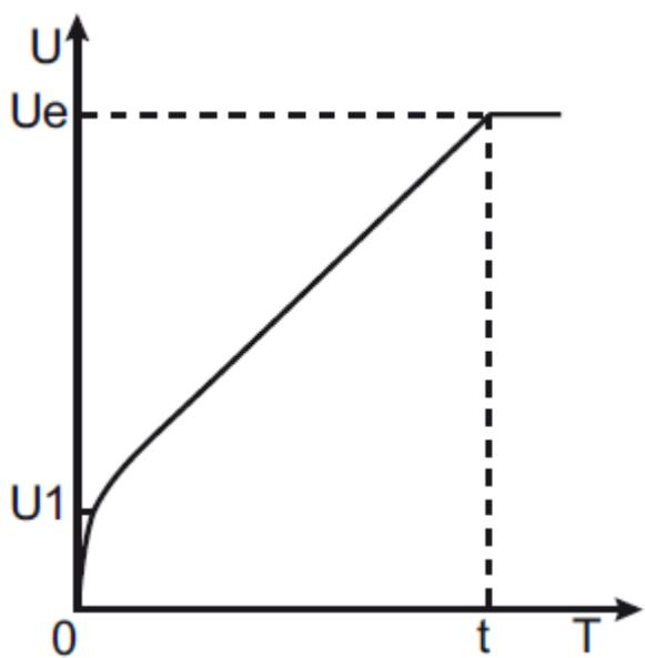
Режим действителен, если параметру F9 присвоено значение «1». На диаграмме представлена динамика изменения напряжения в процессе запуска. При пуске, если ток электродвигателя не превышает 400% от номинального значения, выходное напряжение быстро возрастает до значения  $U_1$ . Далее, напряжение плавно повышается до номинального значения ( $U_e$ ), двигатель плавно разгоняется до номинальной скорости. Затем производится включение байпасного контактора и процесс запуска завершается.
