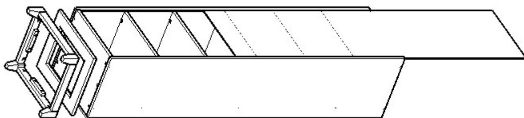
*Установить шкаф в вертикальное положение и монтировать крышку.*
