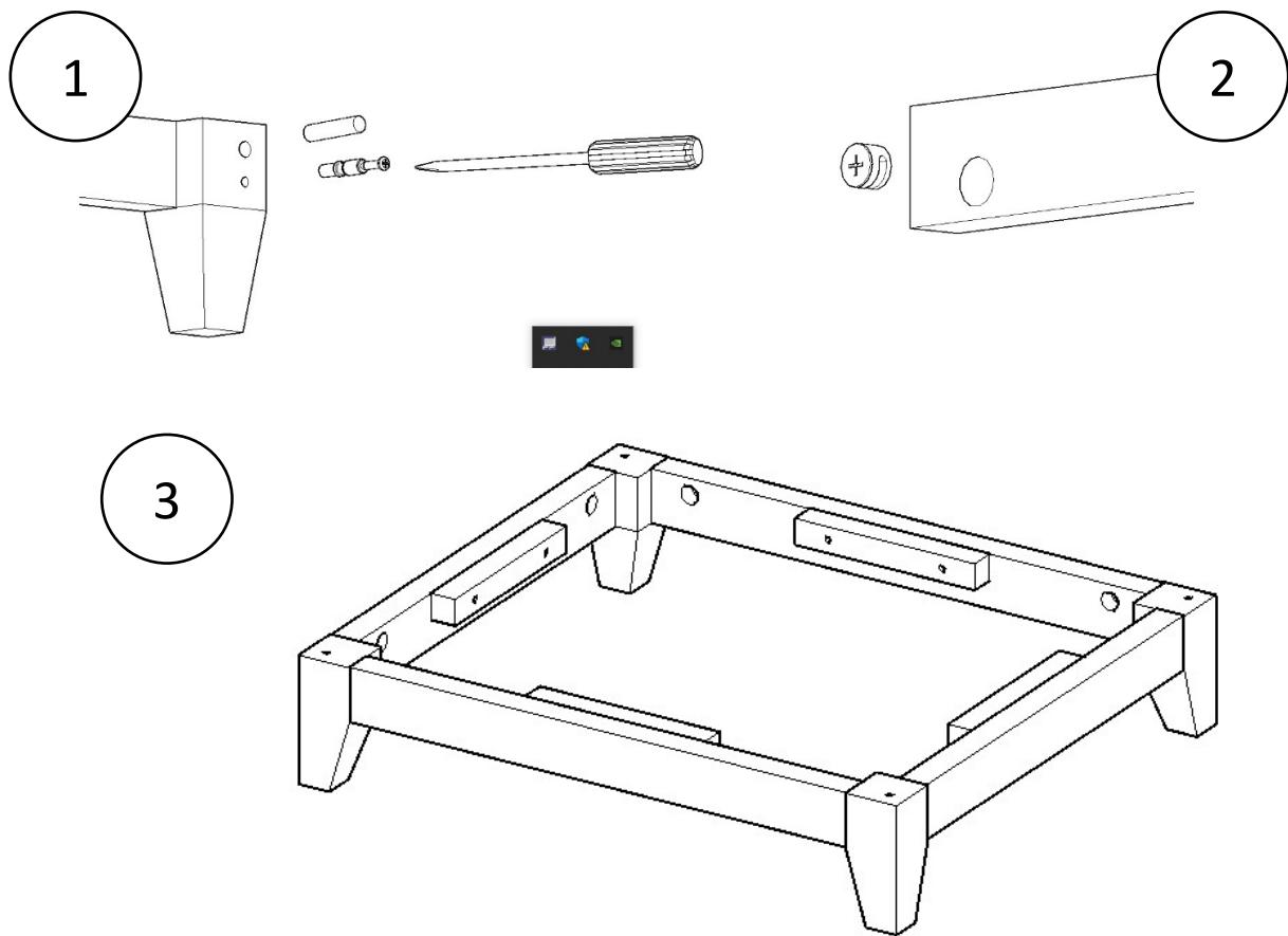
Установить эксцентриковые стяжки в отверстия Ø20мм и ввинтить дюбели в соответствующие отверстия Ø5мм:
