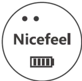
На дисплее горит две синих лампы: включен *режим 2* (давление струи 206-413 кПа).
