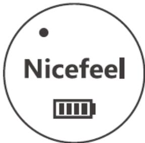
На дисплее горит одна синяя лампа: включен *режим 1* (давление струи 69-275 кПа).
