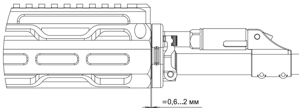
**Шаг 14:** Произвести сборку винтовки. Крышка ствольной коробки должна свободно устанавливаться при полностью собранном изделии.
