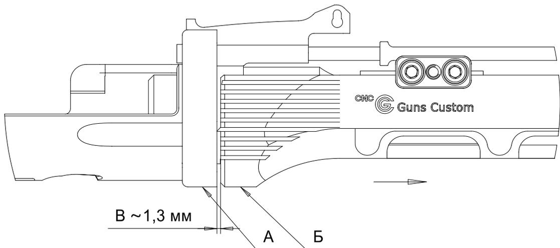
**Шаг 11:** Установите кронштейн прицела №9, верхнее полуцевье №10 и планку тепловизионной насадки №4 затянув винты с моментом не более 4 Нм.
