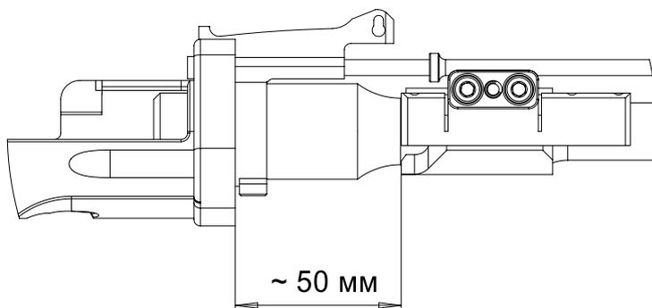
**Шаг 7:** Муфта с фиксатором должна с затиранием вращаться на стволе «от руки».
