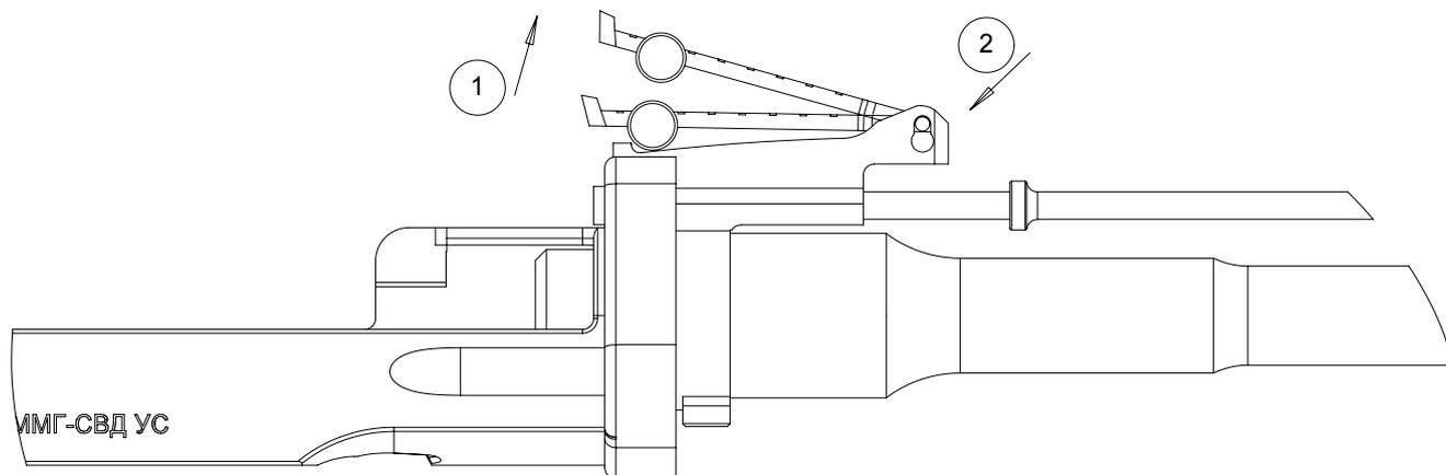
**Шаг 4:** Установите крепежную муфту и фиксатор на ствол.
