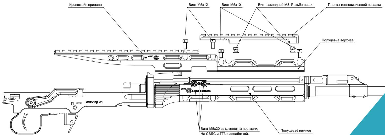
**Шаг 13:** На завершающем этапе сборки затянуть винты №16 крепежной муфты.
