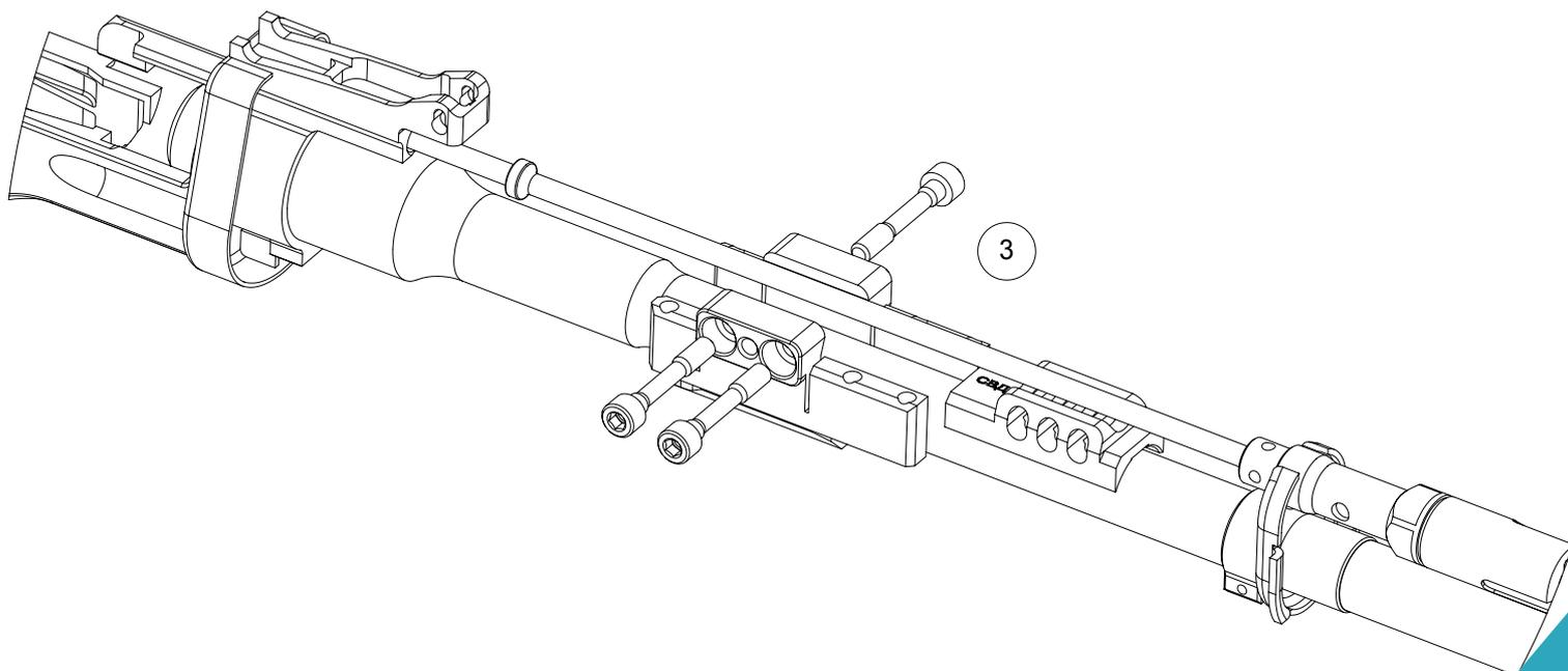
**Шаг 6:** Задвинуть муфту на утолщенную часть ствола перед патронником на расстоянии примерно 50 мм от ствольной коробки, как показано на рисунке.
