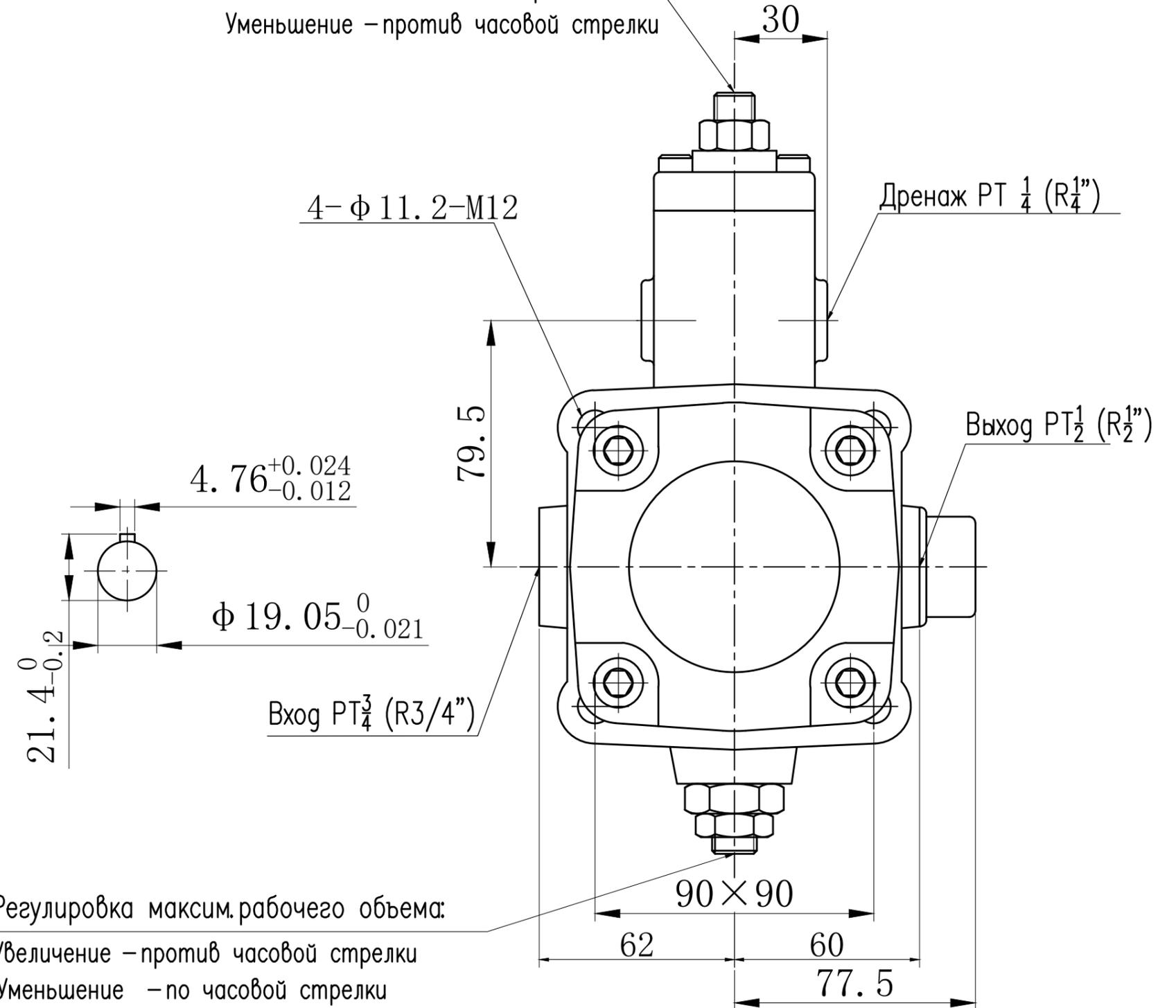
Регулировка максим. рабочего объема:
