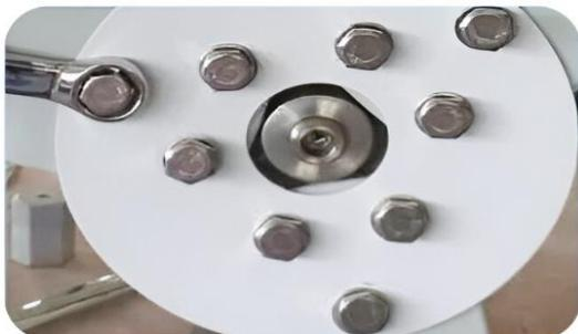
1. Установите лопасти и прижимную пластину на вал ветрогенератора. Закрутите гайки для крепления лопастей. (см. рисунок выше)
