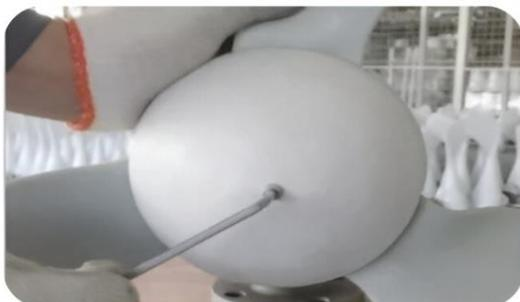
3. Установите конус - обтекатель на вал ветрогенератора. При наличии болта для крепления обтекателя закрутите его шестигранным ключом.
