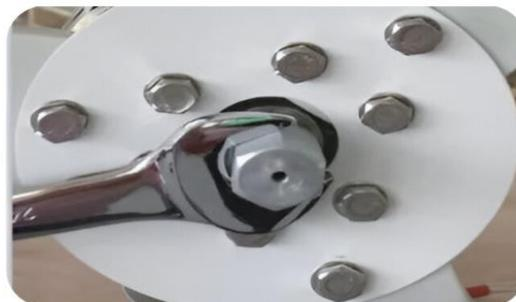
2. Установите прижимную гайку и закрутите на вал ветрогенератора.
