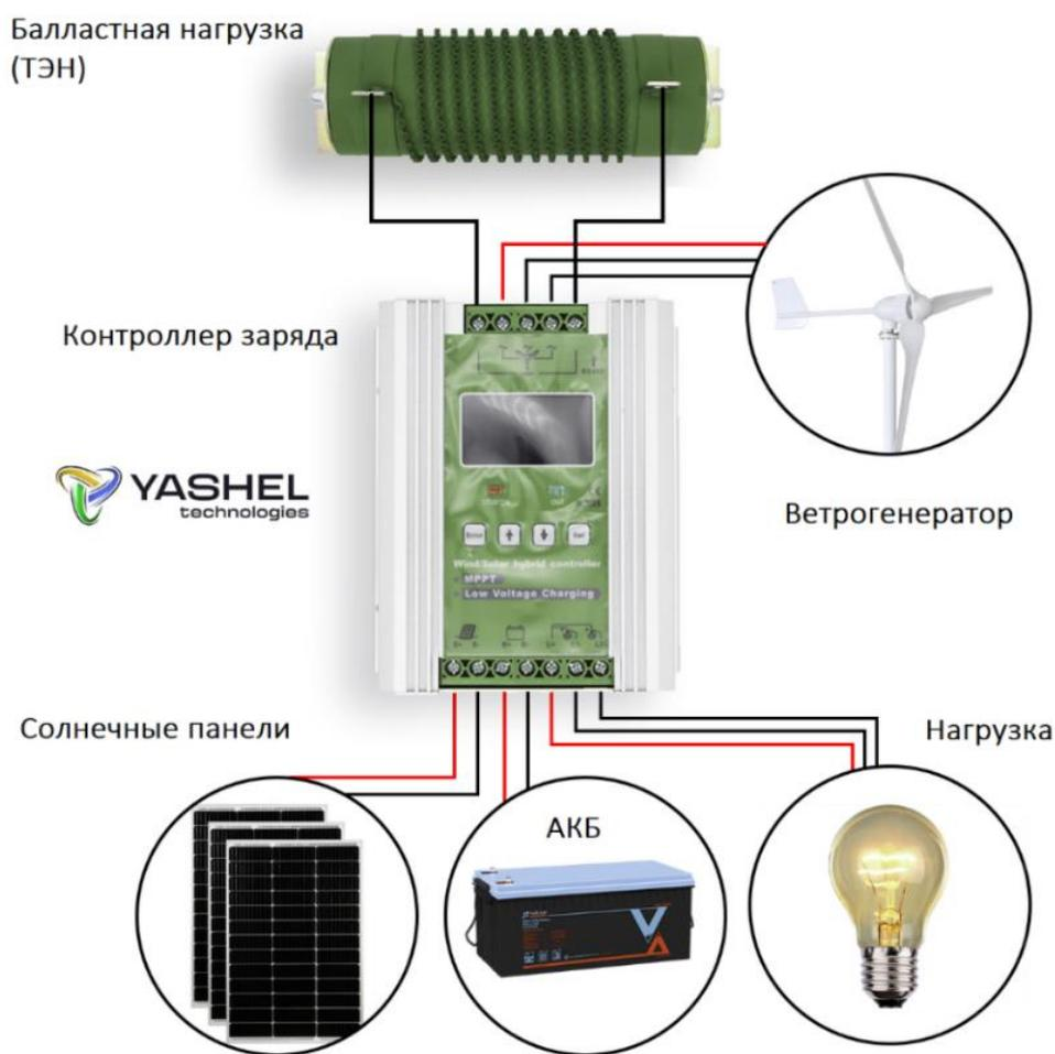
Рисунок 1 – Схема устройства ветроэлектрической установки.
