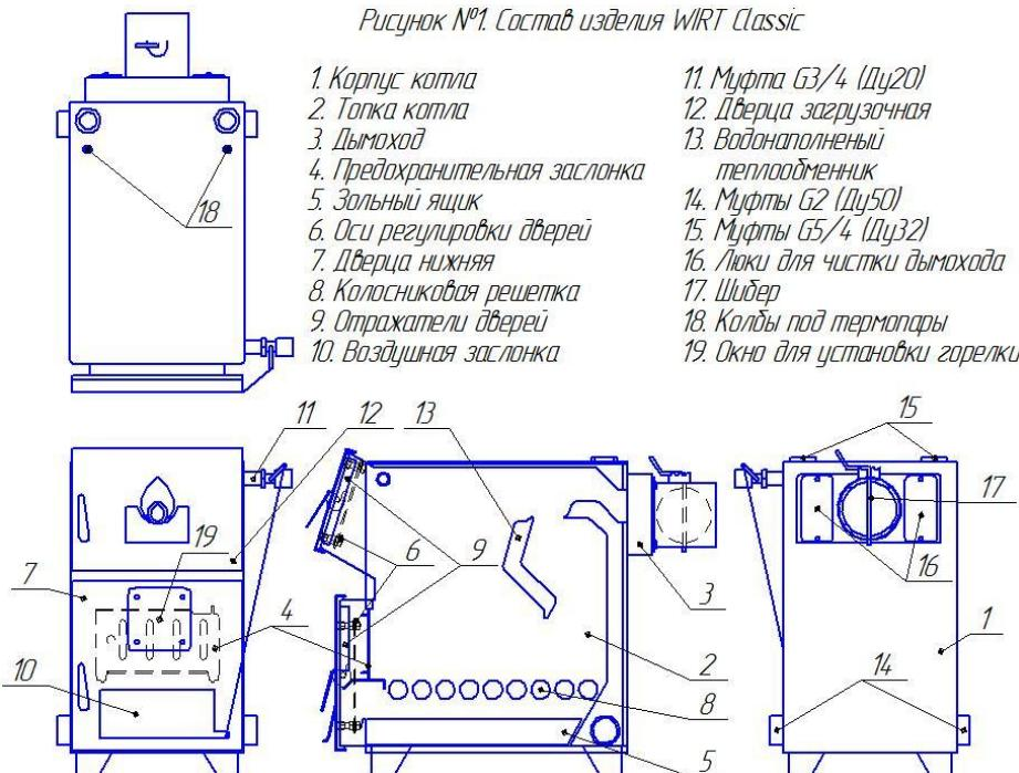
Котел состоит из корпуса 1, топки 2, дымохода 3. В нижней части топки устанавливаются предохранительная заслонка 4 и зольный ящик 5.
