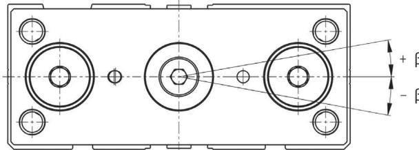
**Максимальный зазор в опорах скольжения, без нагрузки**
