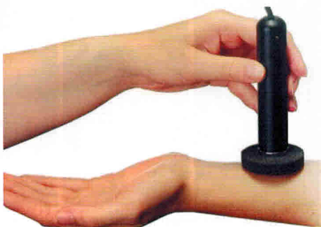
Рис. II-23. Принцип работы и измерений с помощью мексаметра
