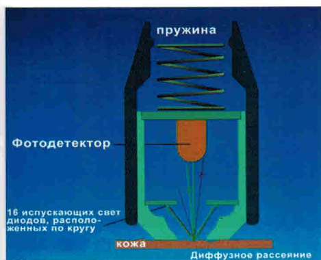
Рис. II-23. Принцип работы и измерений с помощью мексаметра
