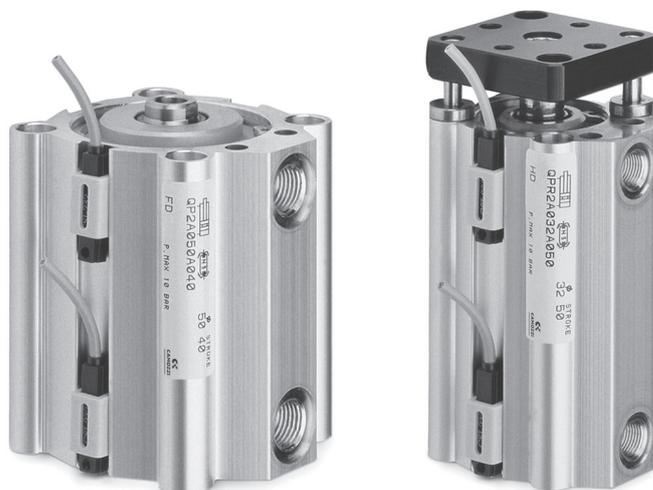
Магнитные, одно- и двустороннего действия, цилиндры пневматические короткоходовые Серии QR и QPR представлены 10 различными диаметрами поршня – от 12 до 100 мм. Компактные размеры цилиндров позволяют использовать их в ограниченном пространстве, главным образом для фиксации и прижима. Монтаж на лапах или на кронштейне. Корпус цилиндра имеет пазы для крепления магнитных датчиков положения.
