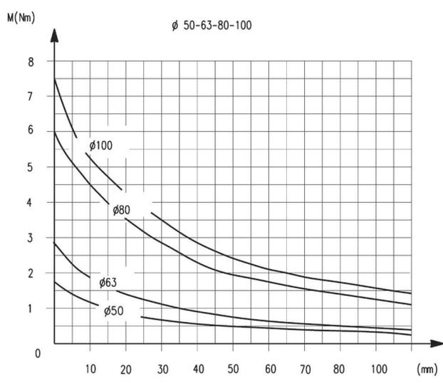
**ЗАВИСИМОСТЬ МАКСИМАЛЬНО ДОПУСТИМОЙ РАДИАЛЬНОЙ НАГРУЗКИ ОТ ПЛЕЧА**
