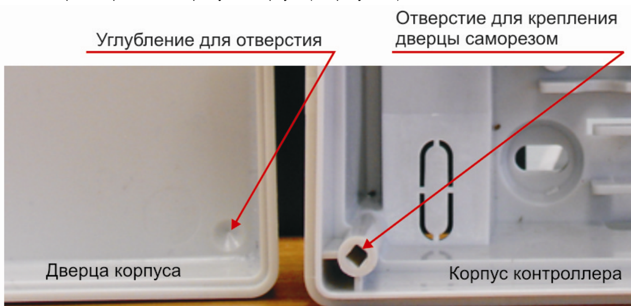
Рисунок 3. Схема «жесткого» крепления дверцы к корпусу контроллера.
