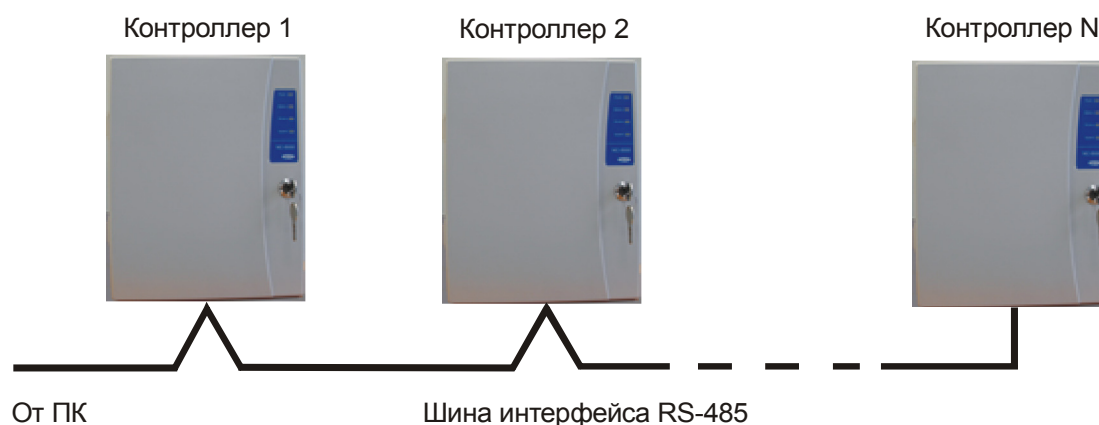
а). Соединение контроллеров по топологии «Шина».
