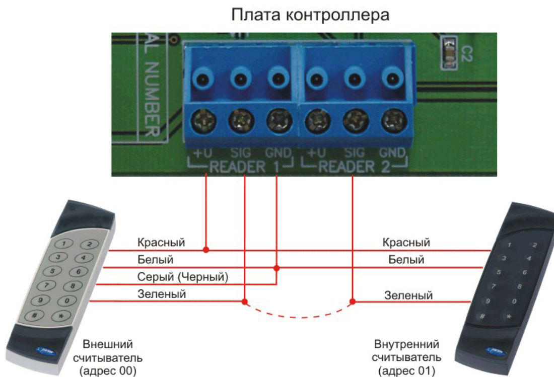
Рисунок 8а. Подключение считывателей серии NR-xxx к контроллерам NC-1000/NC-5000.
