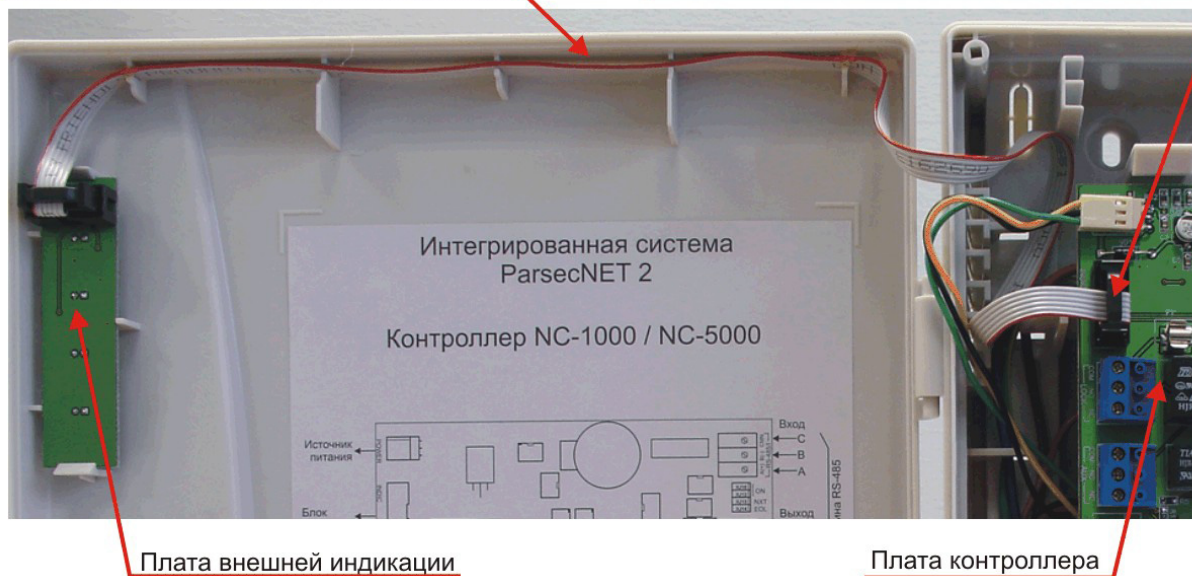
Рисунок 21. Схема подключения платы внешней индикации.
