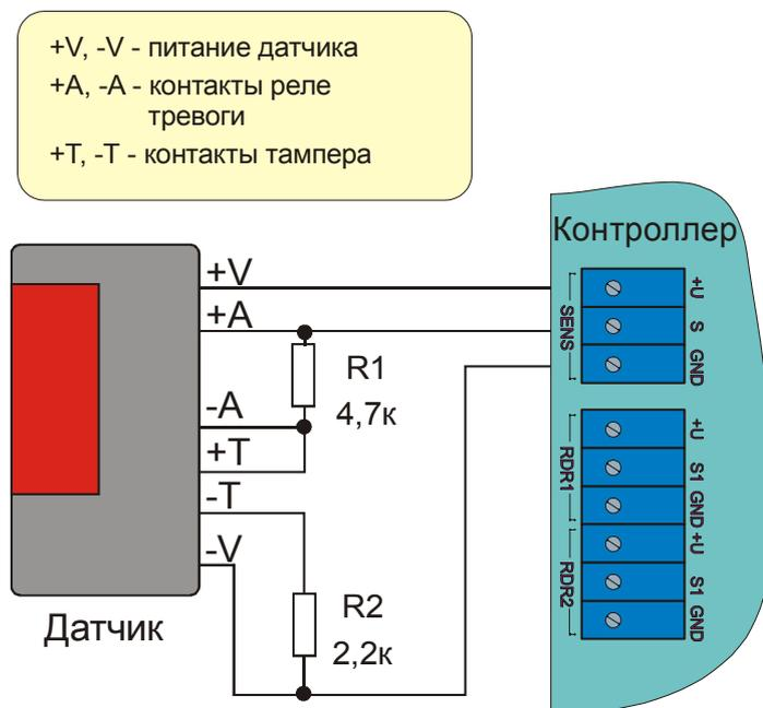
Рисунок 9. Подключение охранного датчика.
