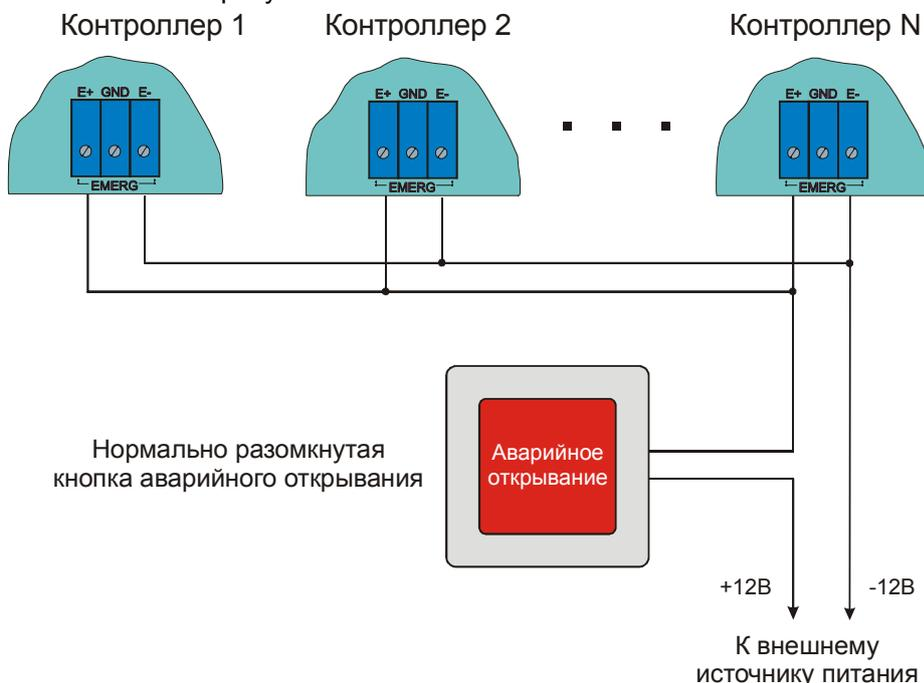
Рисунок 13. Подключение одной кнопки к нескольким контроллерам.
