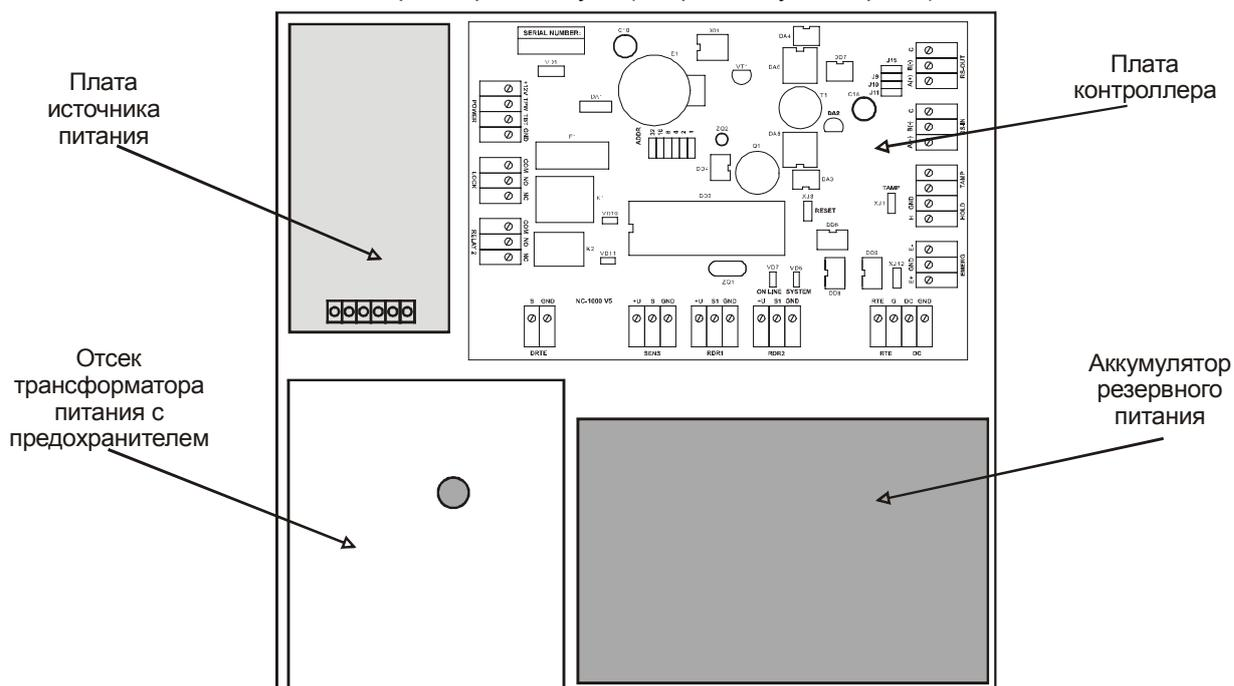
Рисунок 1. Контроллер NC-1000 в кожухе.
