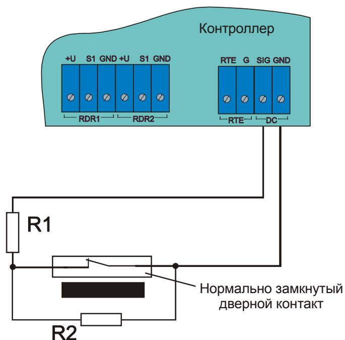
Рисунок 6б. Подключение DC с контролем подводящих проводов.
