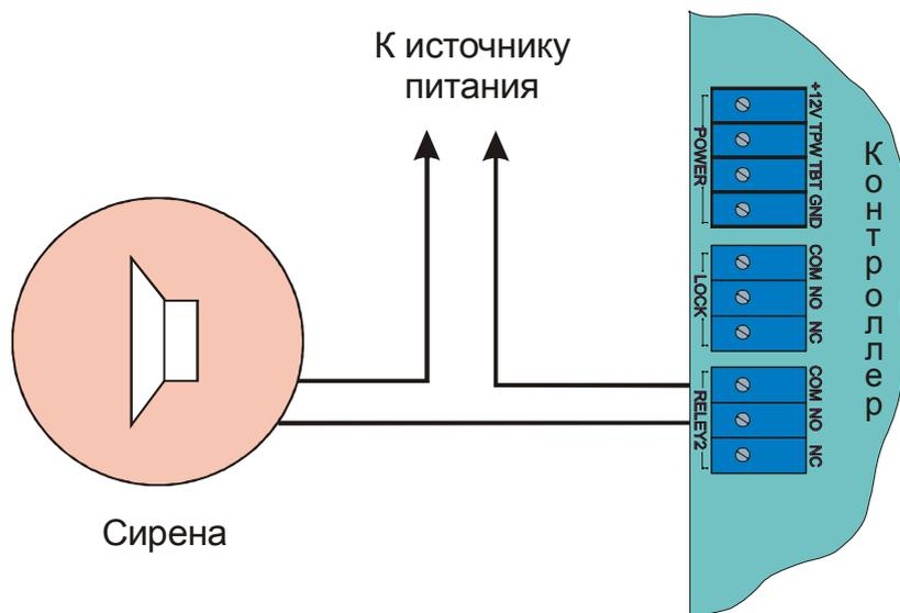
Рисунок 10. Подключение к дополнительному реле.
