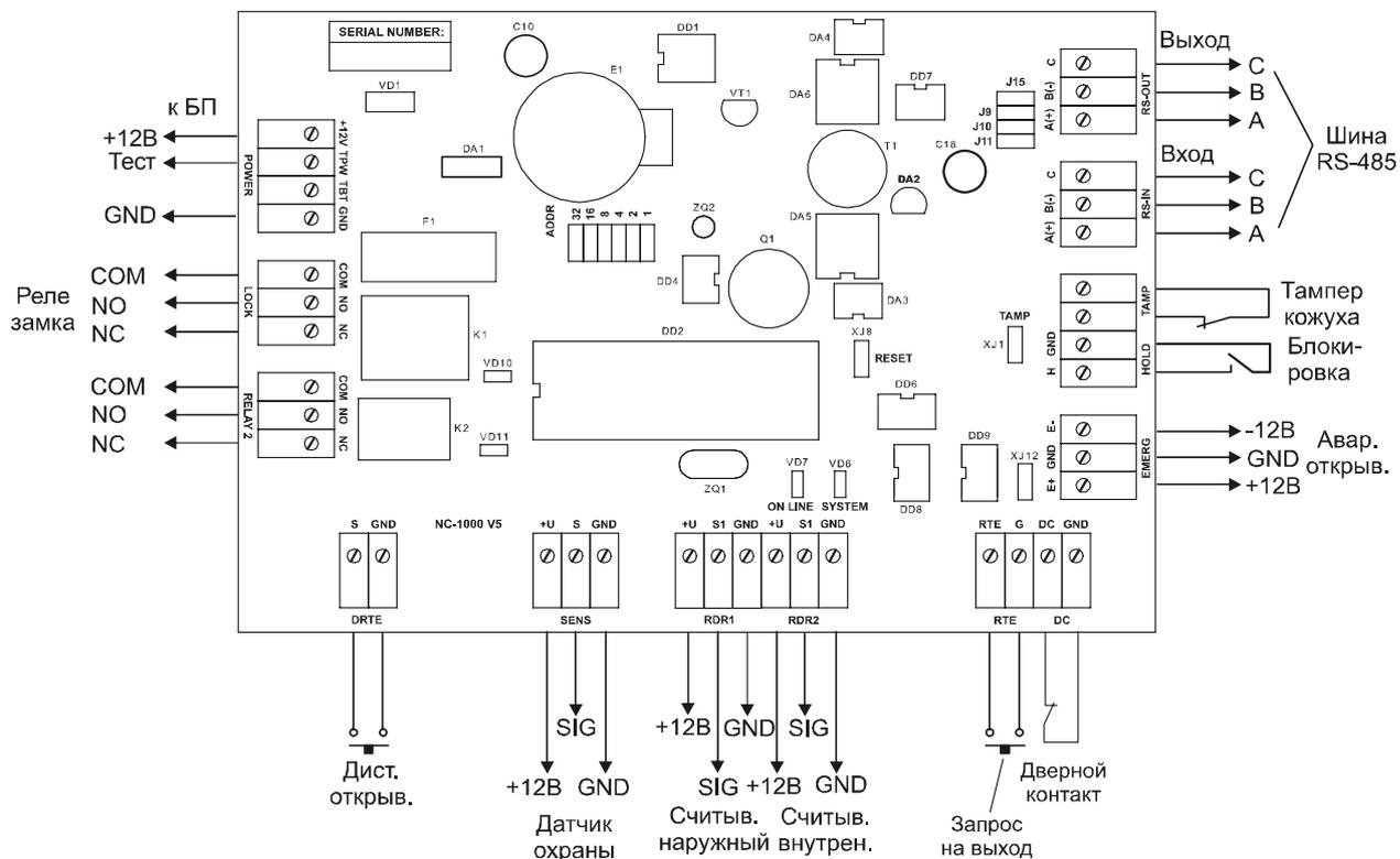
Рисунок 2. Печатная плата контроллера NC-1000.
