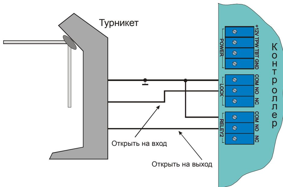
Рисунок 8. Подключение контроллера к турникету.
