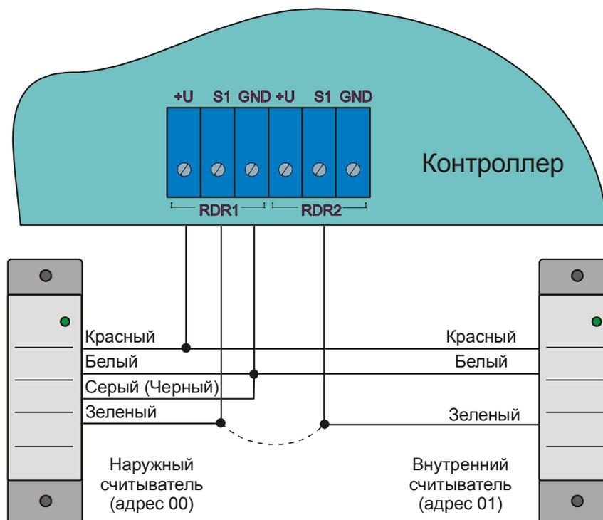
Рисунок 4. Подключение считывателей серии NR-A0x к контроллеру NC-1000.
