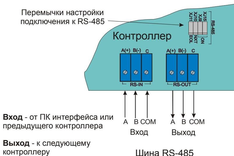
Рисунок 16. Подключение контроллера к шине RS-485.
