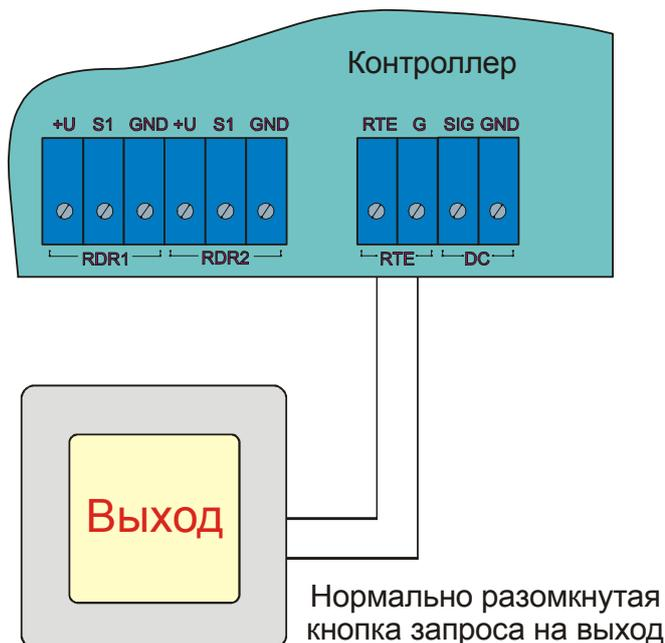
Рисунок 5. Схема подключения кнопки запроса на выход.
