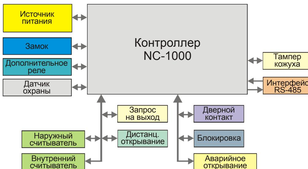
Рисунок 3. Оборудование, подключаемое к контроллеру NC-1000.
