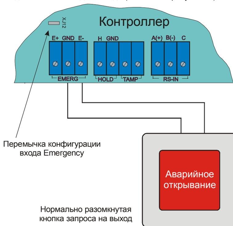
Рисунок 12. Подключение аварийной кнопки к одному контроллеру.
