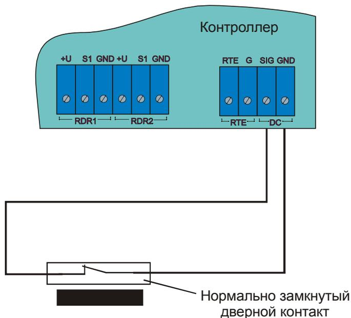
Рисунок 6а. Подключение DC без контроля подводящих проводов.
