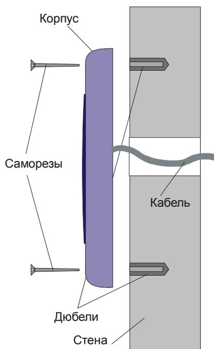
Рисунок 2. Крепление считывателя PR-H05.
