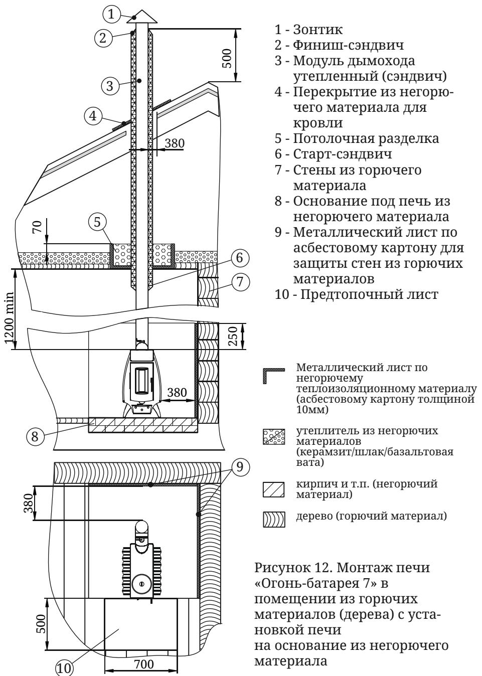
Рисунок 12. Монтаж печи «Огонь-батарея 7» в помещении из горючих материалов (дерева) с установкой печи на основание из негорючего материала
