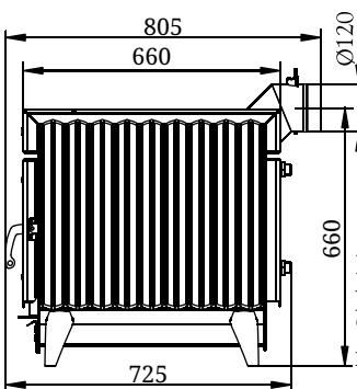
Рисунок 6. Габаритные размеры «Огонь-батарея 9Б» с выходом для трубы назад
