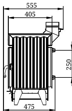
Рисунок 1. Габаритные размеры «Огонь-батарея 5Б» с выходом для трубы вверх
