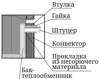
Рисунок 16. Демонтаж теплообменника
