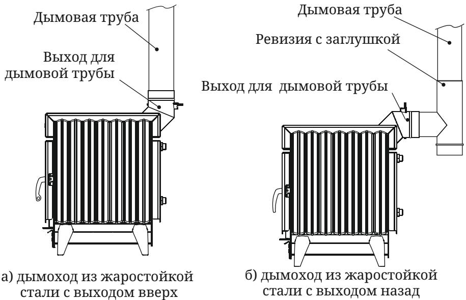
Рисунок 13. Схема присоединения печи к стальному дымоходу
